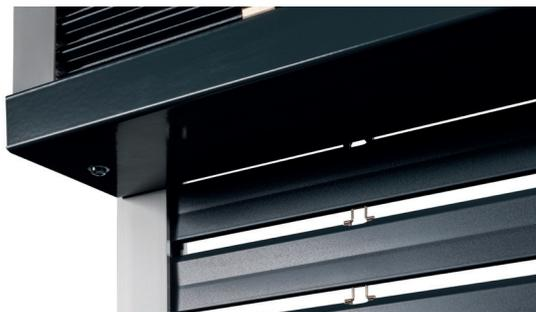
**Plafonnet inférieur de couverture** de la traverse accueillant le rouleau en aluminium anodisé ou thermolaqué. Hauteur standard de 40 mm. Au-delà de 2000 mm de largeur, la tôle livrée est renforcée de 100 mm.
